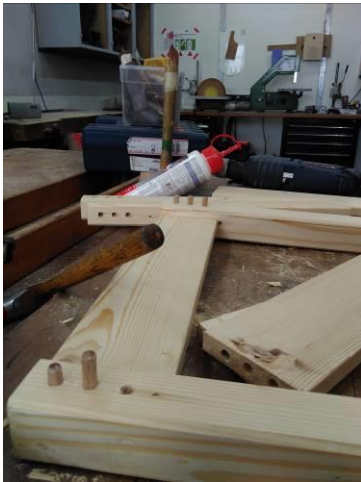
Abbildung 19 Montage der Dübel
