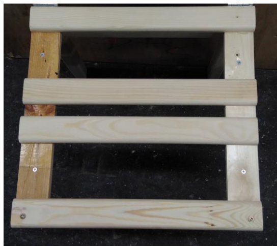
Abbildung 21 Befestigung des Sitzrostes an das Stuhlgerüst
