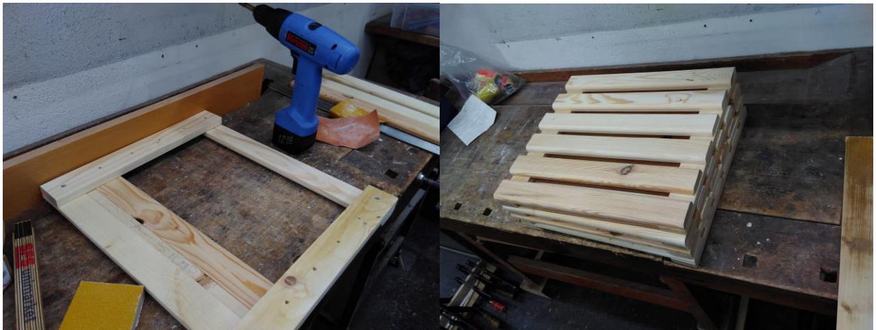
Abbildung 18 Montage der Sitzlatten und fertige Sitzlatten
