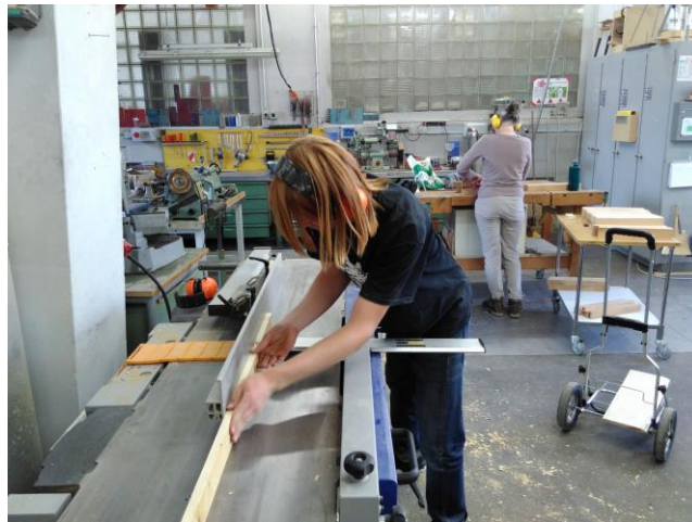
Abbildung 16 Hobeln an der Abrichtungshobelmaschine
