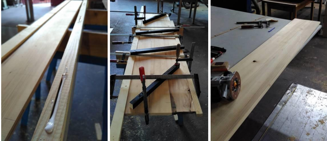
Abbildung 26 Bild eines Schlitzes für Flachdübel
