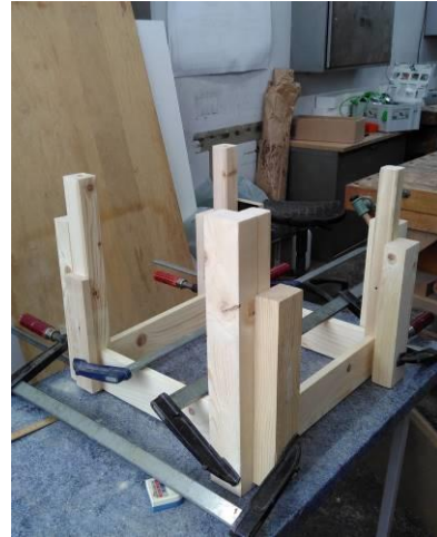
Abbildung 20 Verleimung des Stuhlgerüsts
