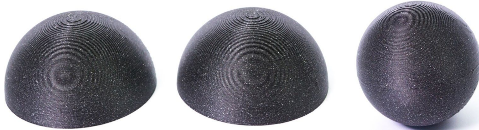
Bild 29 - Eine in zwei getrennten Teilen gedruckte Kugel, die miteinander verklebt sind.
