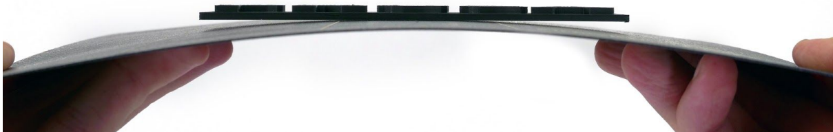
Bild 13 - Entfernen eines Modells von der PEI-Oberfläche durch Biegen der Federstahlplatte
